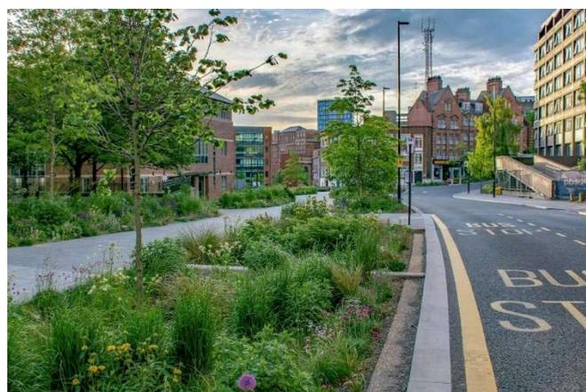
Figura 1: Combinación de Infraestructuras Verde (vegetación) y Azul (canteros de infiltración).
